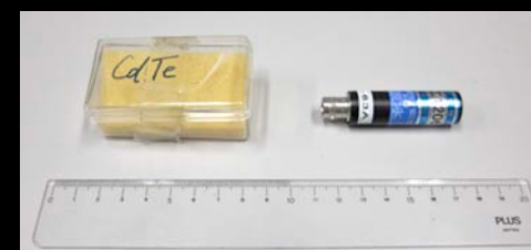
EURORAD, Ohmic type 10mm×10mm×3mm
